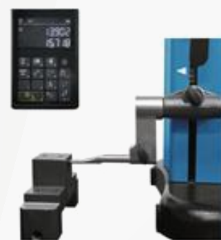
Измерение диаметра (Отображение радиуса/диаметра Одновременно)
